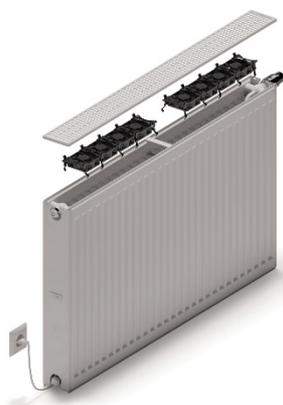
Der **x-flair** vereint die von Kermi bekannte x2-Technologie mit einem innovativen Lüftersystem und ist dabei wie ein herkömmlicher Heizkörper über den Thermostatkopf zu bedienen. Die Drehzahl der Axialventilatoren wird sowohl im Heiz- als auch im Kühlbetrieb vollautomatisch und bedarfsgerecht geregelt.
